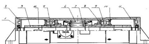
1. 振动源三相异步电动机，包括机座（11），机座（11）内有转轴（4），转轴（4）上安装有转子（7），与该转子相对应的机座（11）内圆上有定子（6）；转轴（4）的两端还安装有偏心块（3）；其特征在于定子（6）两侧的转轴（4）上有轴套（5），轴套（5）上有主轴承（9），该主轴承的内、外圈分别安装在轴套（5）上和机座（12）上；所说的机座（11）两端固定有底脚（2），底脚（2）内侧中心有轴承室，轴承室内有安装有定位轴承（1），转轴（4）两端安装在该定位轴承内。
